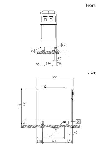
Electrical inlet (power) Equipotential screw
